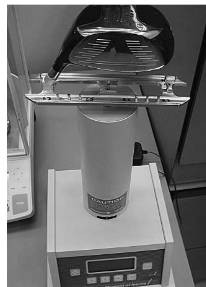
慣性モーメントテスト クラブヘッドの重心を通る垂直軸のまわりのヘッドの慣性モーメントを測定する ※慣性モーメント(Moment of Inertia):回転運動に対する抵抗の大きさを表す 写真提供:R&A Rues Limited
