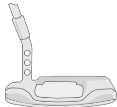
(c) ネックを貫く穴を有するパター（「単純」ではなく、不適合）。
